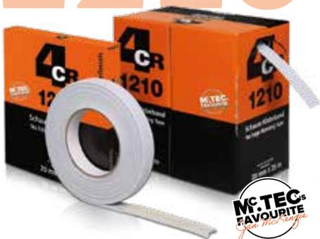
1210 ist eine Kombination aus Abdeckband und Schaumband zum Abdecken von Sicken und Kanten, um harte Lackkanten zu vermeiden. Temperaturbeständig bis 110° C.
